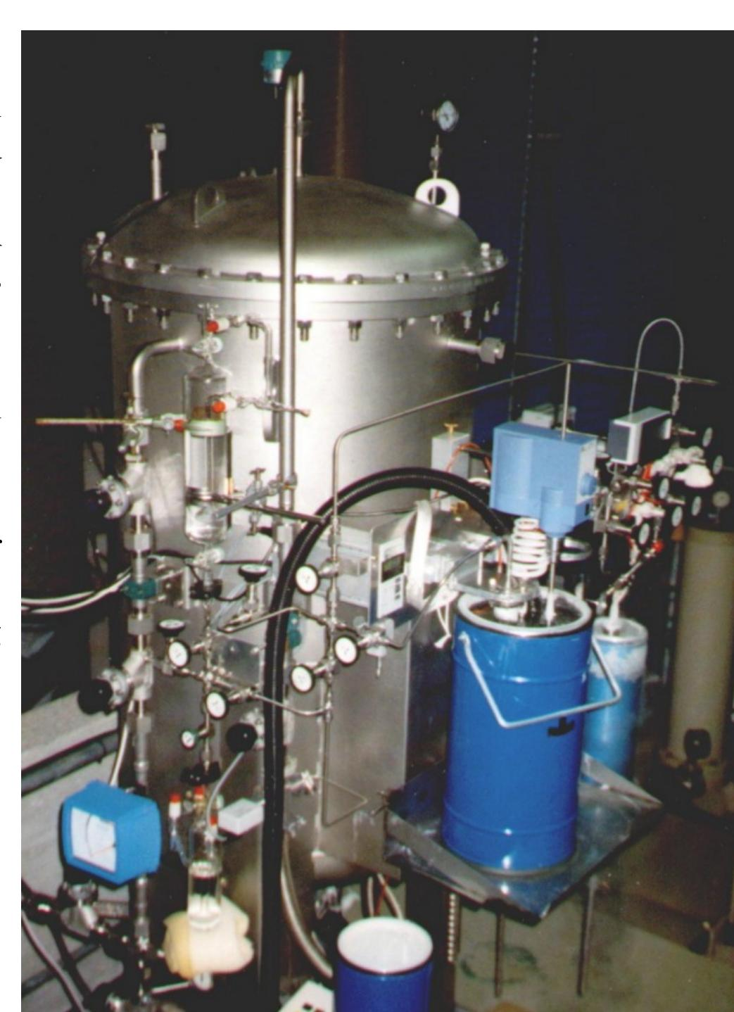
Für diese regelmäßigen Kontrollen steht ein 480 Liter großer „Wasserkessel“ aus Edelstahl zur Verfügung. Er kann vakuundicht verschlossen und mit verschiedenen geeigneten Spülgasen, z.B. Stickstoff oder Helium, betrieben werden.
