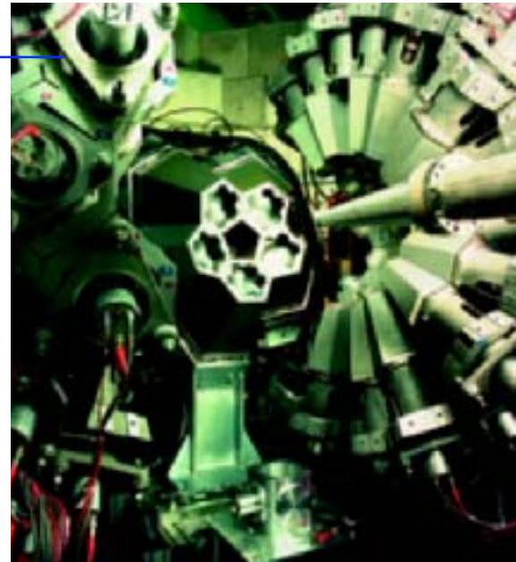
Mit dem „Crystal-Ball“-Detektor der GSI untersuchen die Wissenschaftler besonders neutronenhaltige Kerne. (Foto: GSI)
