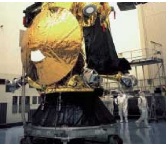
Das Satellitenduo Cassini und Huygens im Reinraum der NASA in Florida. Huygens verbirgt sich hinter dem goldfarbenen Hitzeschild. (Foto: Dornier/NASA)
