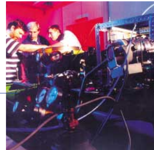
In dieser Apparatur wird mit Hilfe eines Plasmas kohärentes Röntgenlicht erzeugt. (Quelle: Max-Born-Institut für Nichtlineare Optik und Kurzzeitspektroskopie)
