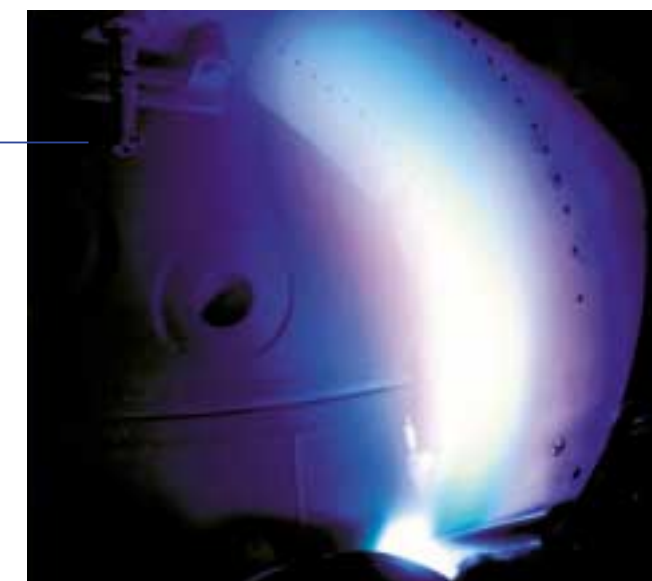
Lasererzeugtes Plasma. Emission im sichtbaren Licht. (Quelle: FhG-IWS/VDI-TZ)
