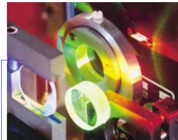
Herzstück der Laserkontrolle chemischer Reaktionen ist der Laser-Pulsformer. Er zerlegt Licht in seine spektralen Bestandteile. (Quelle: Inst. für Experimentalphysik I, Uni Würzburg / Philip Morris)
